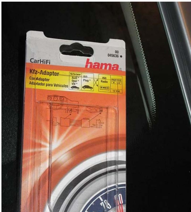
Diese Stecker, die zwischen Radio und fahrzeugseitigem Strom-Stecker eingebaut werden, dienen bei einigen Fahrzeugmodellen (und ganz speziell bei VW) zum Tauschen von Dauerplus und geschaltetem Plus – alle anderen Anschlüsse werden 1:1 durchgeschleift. Dadurch ist für unseren Zweck auch sichergestellt, dass auf der Radioseite ALLE benötigten Anschlusspins bereits belegt sind.
