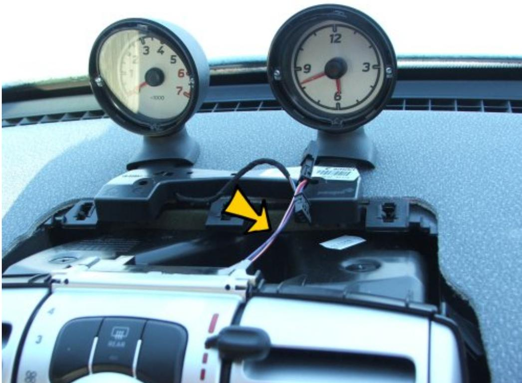
Die Anzeigen mittels zwei Schrauben (nicht im Bild) befestigen. Damit ist der Einbau bereits abgeschlossen. Sollten in der Abdeckung noch nicht die zwei Aussparungen (nächstes Bild, lila eingefärbt) vorhanden sein, müssen diese noch gemacht werden. Hier bietet sich eine Feile oder (wenn es schnell gehen soll) ein Multi-Dremel an.
