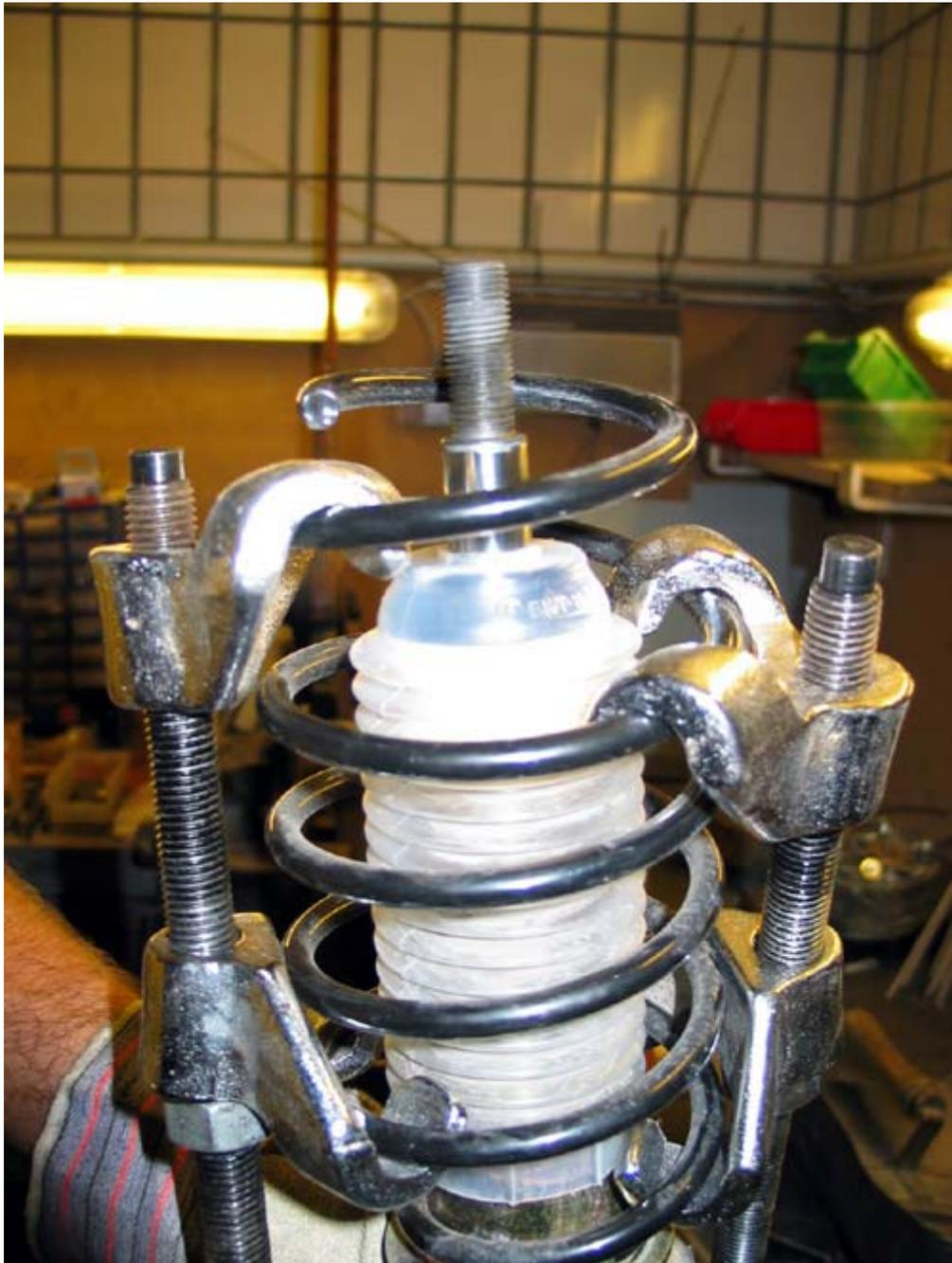
Beim obigen Bild ist der Federteller bereits entfernt und die Feder reif zum Austausch.
