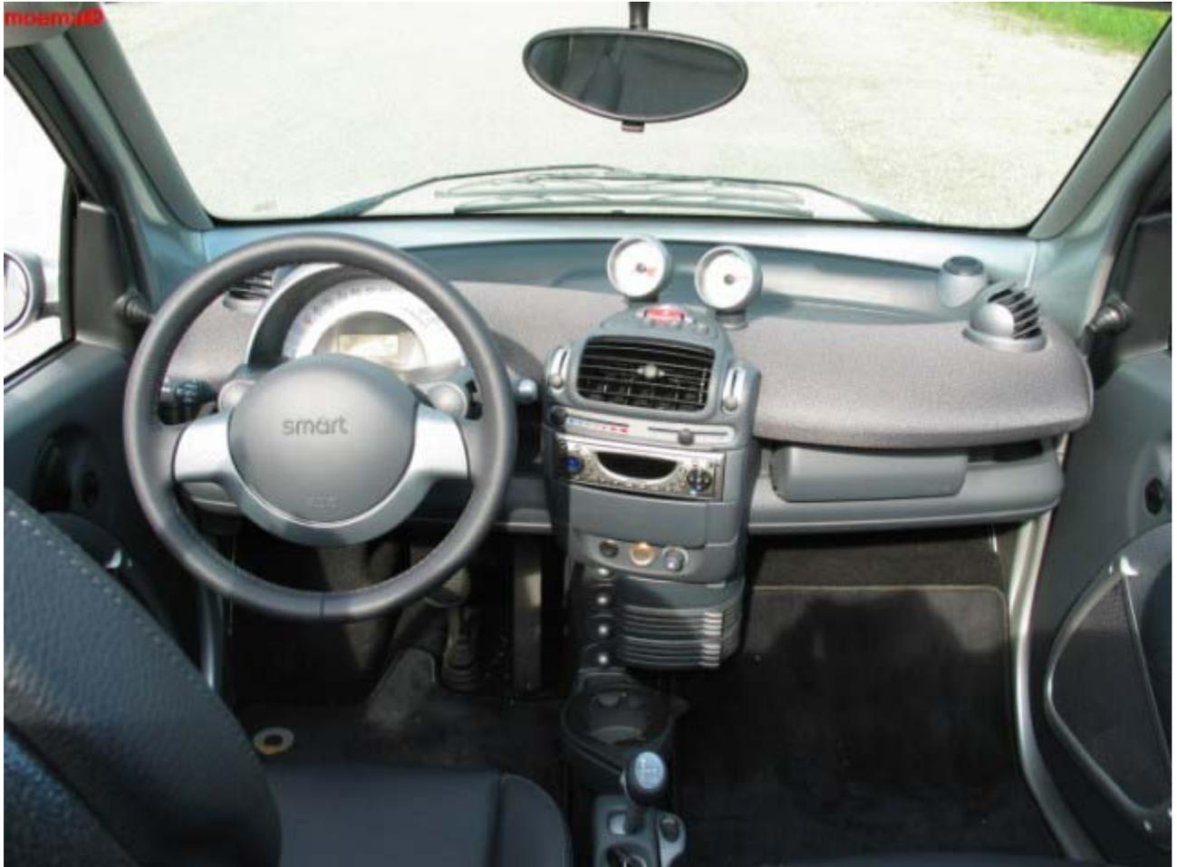
Auf dem Photo siehst du rechts neben der Uhr zwischen Windschutzscheibe und Armaturenbrett so einen komischen "Eierbecher"! Das ist das Gehäuse, wo der Zusatzhohtöner eingebaut ist.
