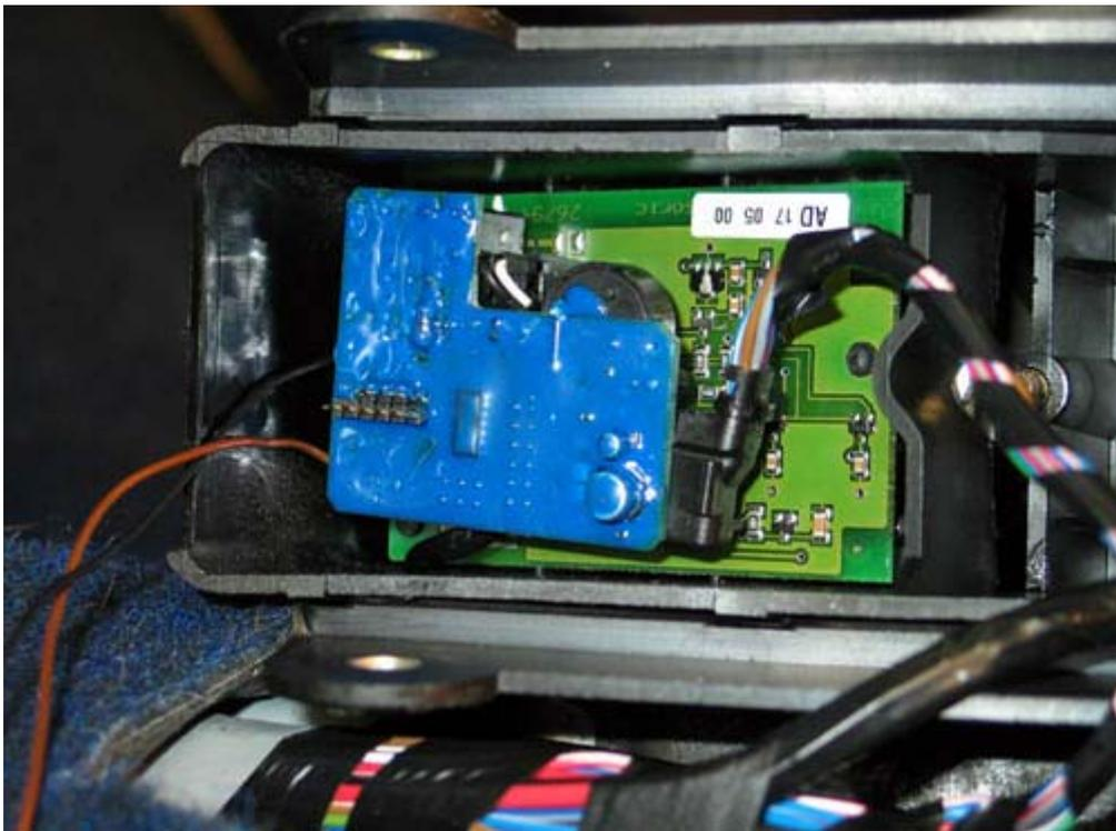
Hier nun die ausgebaute Schaltbox von unten, wo die Platine von cbffm schon aufgesteckt ist. Alles ganz easy: Originalstecker ab und auf die neue Platine stecken und dann diese Platine auf den Originalstecker in der Schaltbox! Nun noch die Platine gegen "Abfallen" sichern - entweder mit Kleber oder wir nahmen ein Tuchknäuel, das wir beim Zusammenbauen der Schaltbox zwischen Teppich und Platine "gequetscht" haben, damit sie sich nicht losrütteln kann!
