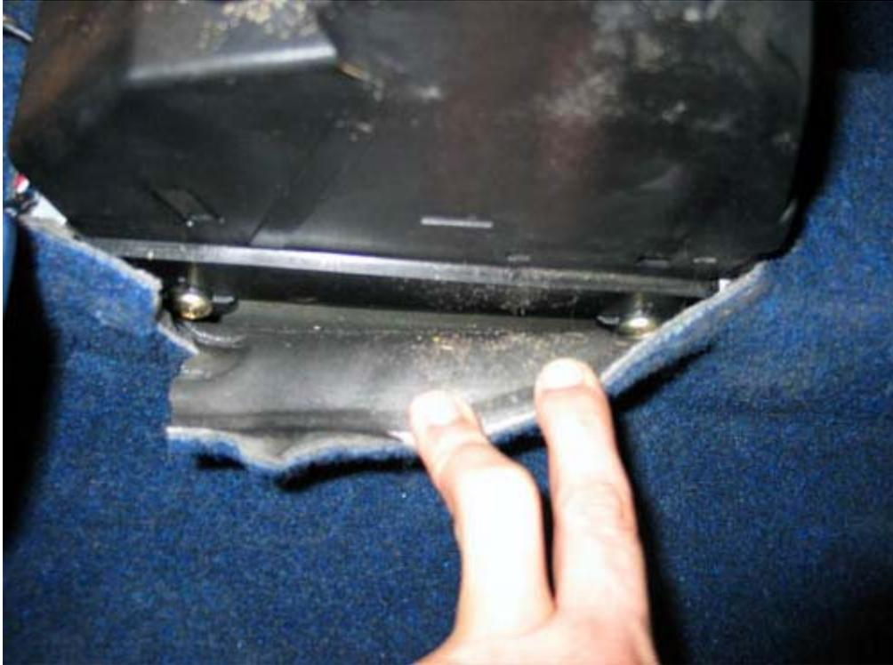
Dann die Mittelunnelverkleidung demontieren (Schaltknauf mit starken Ruck abziehen - Schraube unter der Handbremse lösen, dann kann das Plastikteil abgehoben werden). Um an die 4 Schrauben der eigentlichen Schaltbox zu kommen, muss entweder der Teppich raus bzw. halbseitig hochgeschlagen werden oder, wie wir es gemacht haben, der Teppich eingeschnitten werden. Das ist weniger Aufwand und die Schnitte sieht man nachher überhaupt nicht mehr!!
