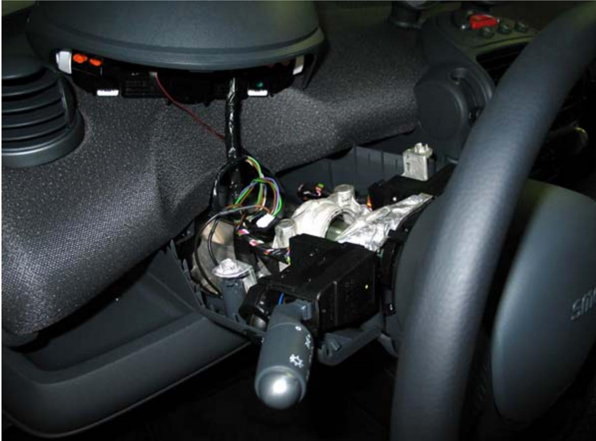
Die Leitungen von Carsten's Platine enden momentan beim Sicherungskasten! Diese müsst ihr verlängern und dann könnt ihr sie einfach neben dem Sicherungskasten in Richtung Lenkrad durchfädeln. Eventuell ist es hilfreich, die untere Lenksäulenverkleidung zu entfernen. Diese ist nur gesteckt und muss lediglich etwas hin- und hergedrückt und in Richtung Sitz gezogen werden.
