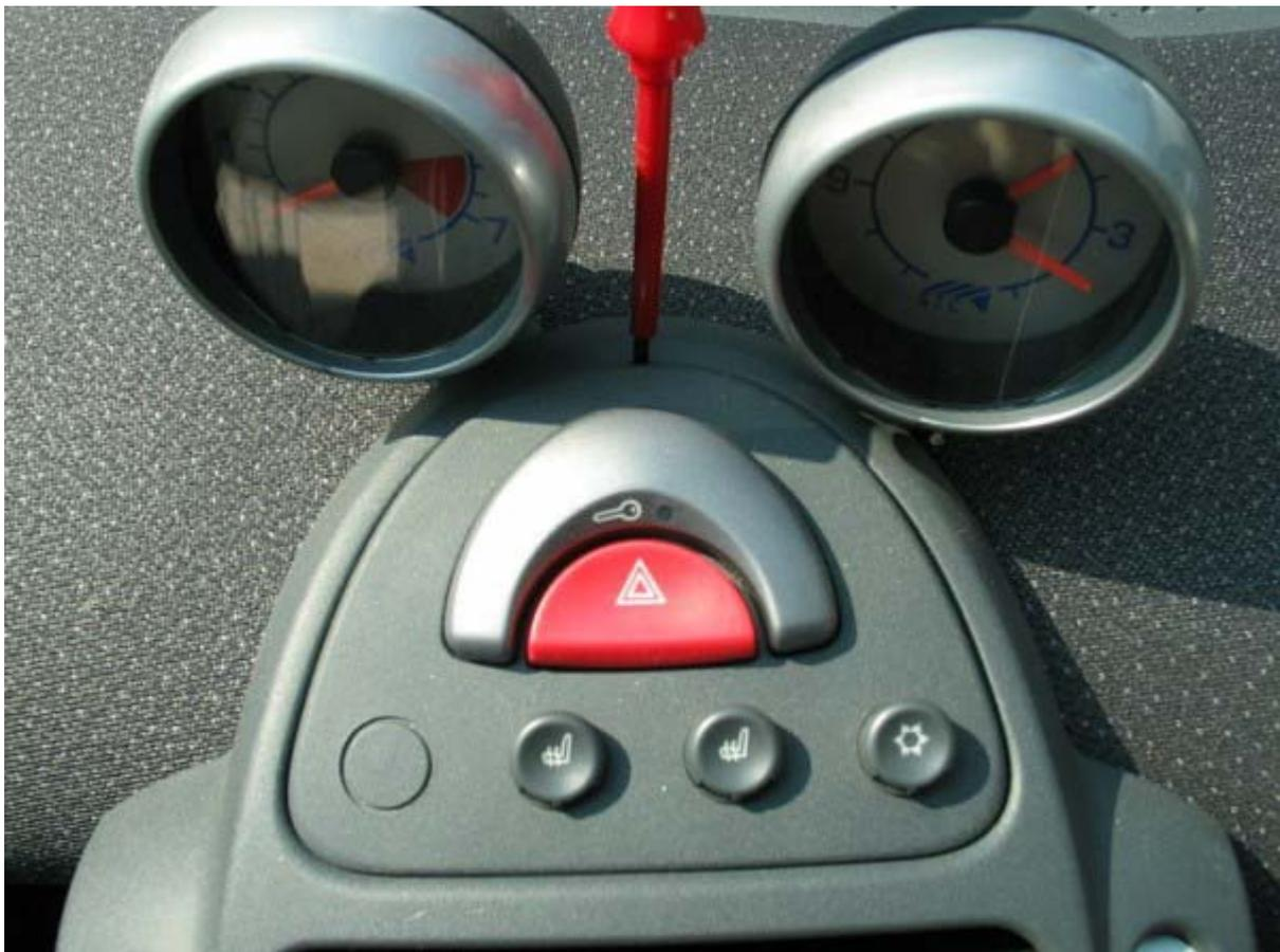
Die Insel wird durch 3 ganz ordinäre Klammernasen gehalten, da kann nichts abbrechen ---> nur aufpassen, dass vom "Hilfswerkzeug" keine Dellen im Plastik entstehen 😊
