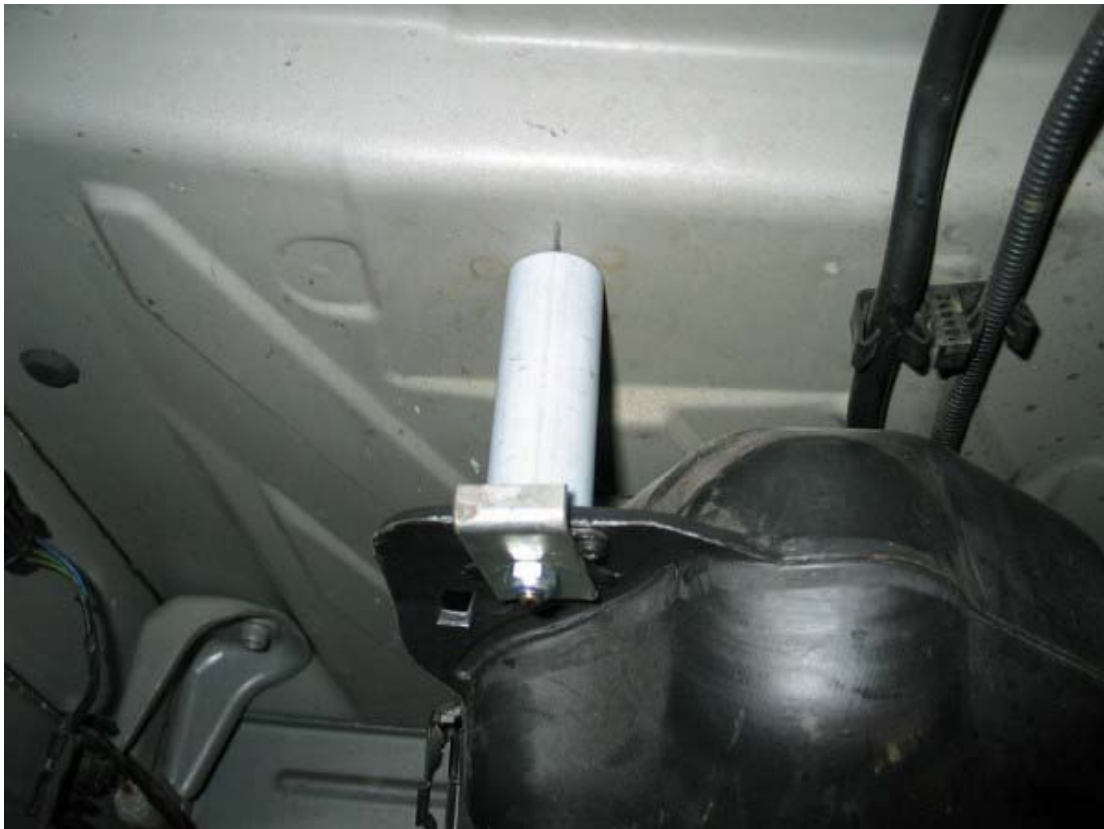
Hier der 33 Liter Tank im eingebauten Zustand. Links gut zu sehen, wie wir nun beim 2. Umbau im CDI die fehlende 5. Halterung gelöst haben!
