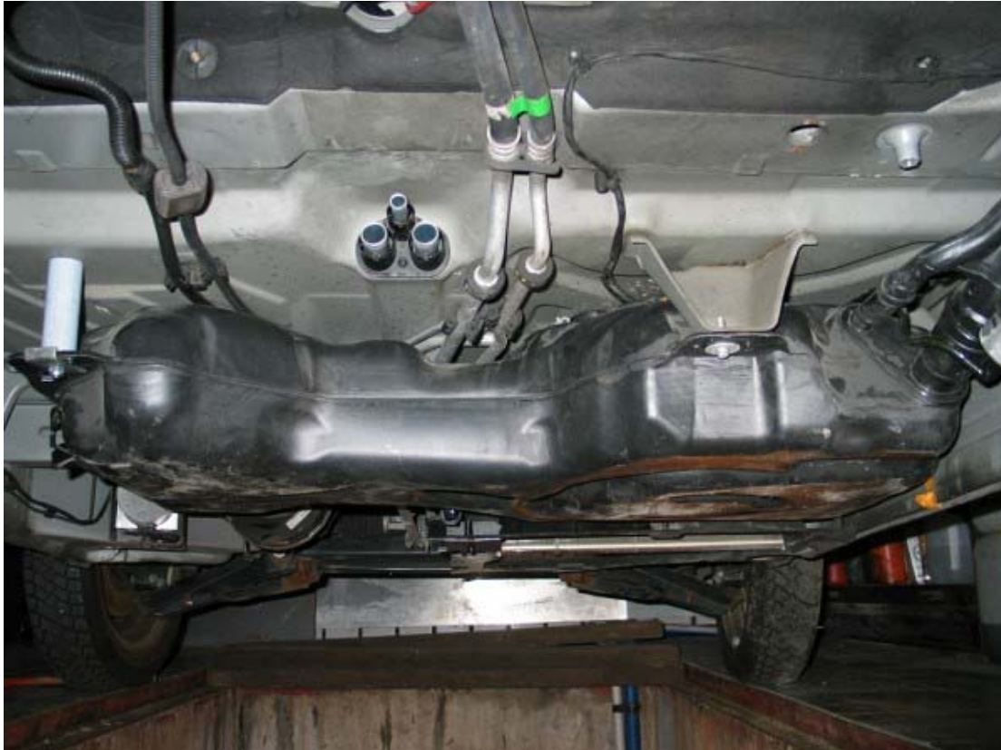
Hier der 33 Liter Tank im eingebauten Zustand. Links gut zu sehen, wie wir nun beim 2. Umbau im CDI die fehlende 5. Halterung gelöst haben!
